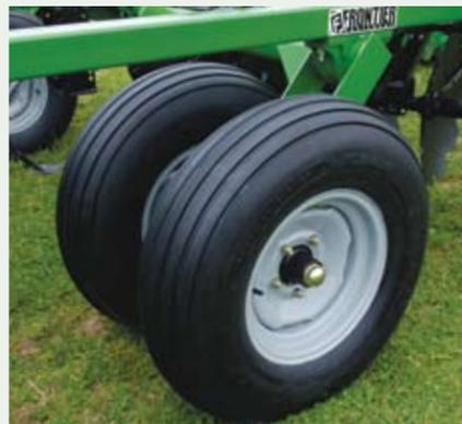
Optional dual wheels provide higher flotation on the DH1510 and DH1512 models. Single wheels are standard.
